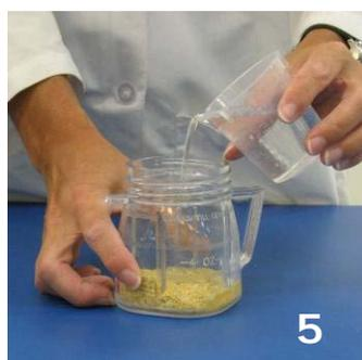
Retire el vaso, inviértalo y déle unos golpecitos para soltar el triturado que pudiera estar atrapado alrededor de las cuchillas. Retire la base y la unidad de cuchillas y agregue 100 mL de agua de la canilla.
